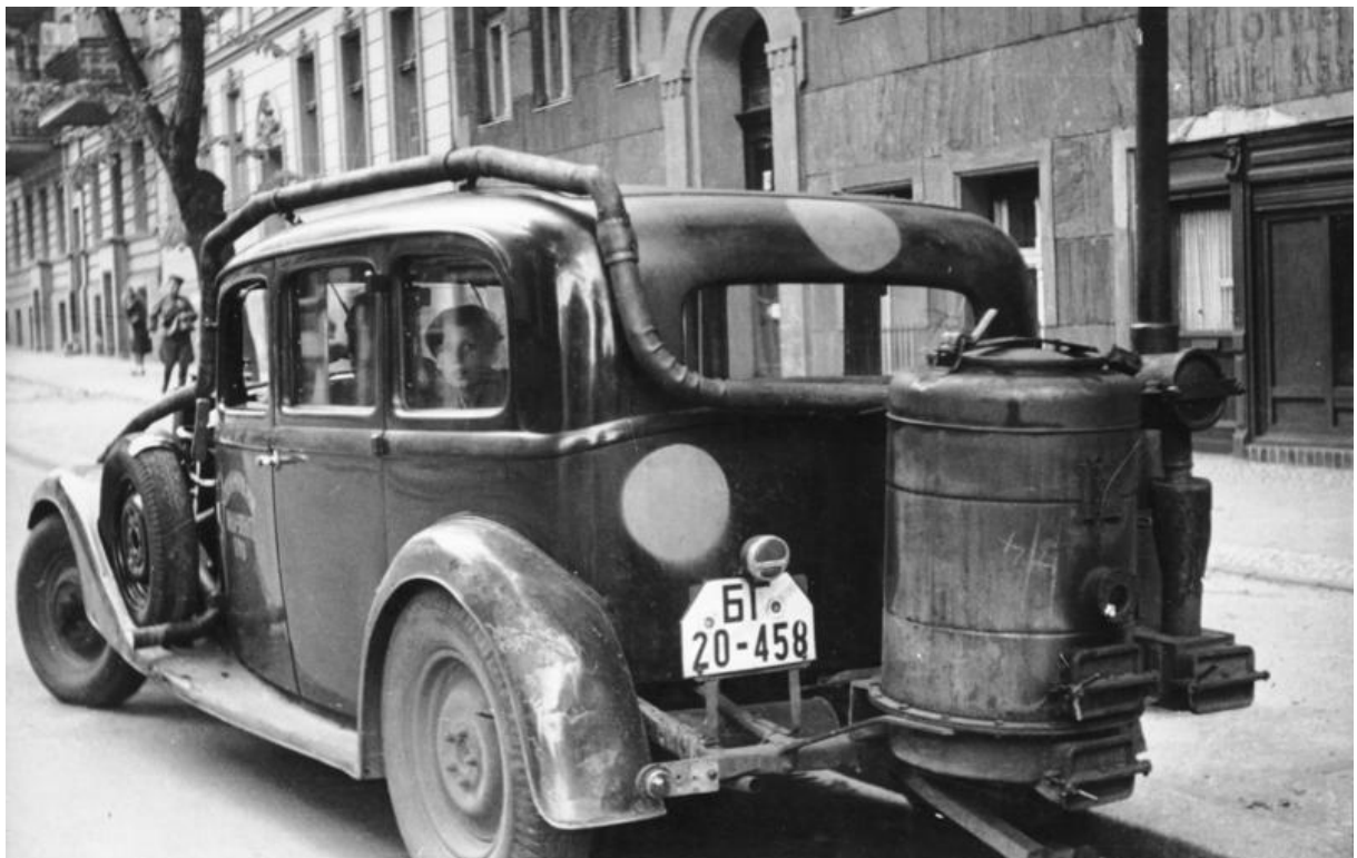
Véhicule équipé d'un gazogène, 1945
